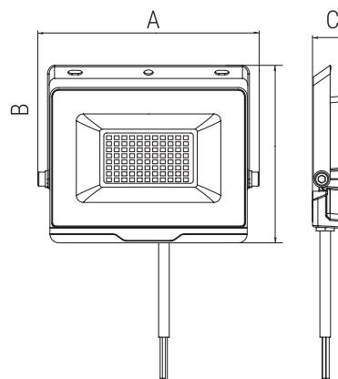
**⚠ Attenzione:** per il collegamento elettrico utilizzare un cavo H05RN-F 3x1,0mm<sup>2</sup> e un dispositivo di connessione con morsetti a vite (conforme alla norma EN 60998-2-1) a tre vie, tensione nominale 250VAC, per conduttori sezione 1,0mm<sup>2</sup>.
